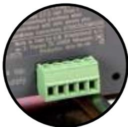
Module avec connecteur de terminaison Mâle
